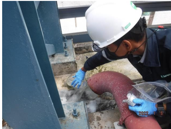
การเก็บตัวอย่างน้ำจากท่อน้ำทิ้งจากหอผึ่งเย็น (Cooling Tower)
