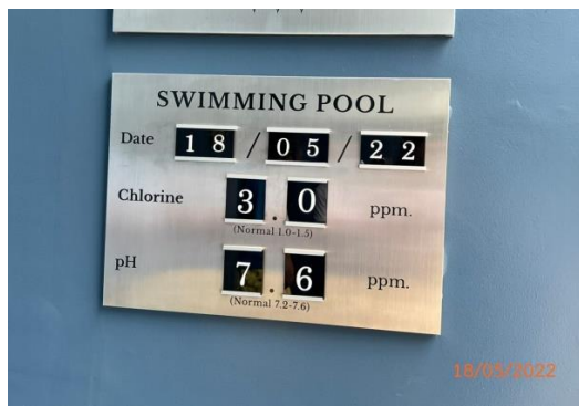
รูปที่ 3-57 การตรวจวัด pH และคลอรีนคงเหลือ
